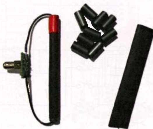
Obr. 4. Konstrukce napájecího oddělovacího transformátoru dle [1]
