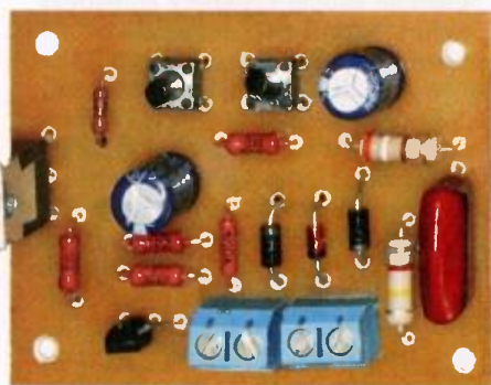
Obr. 1. Deska se součástkami časového spínače
