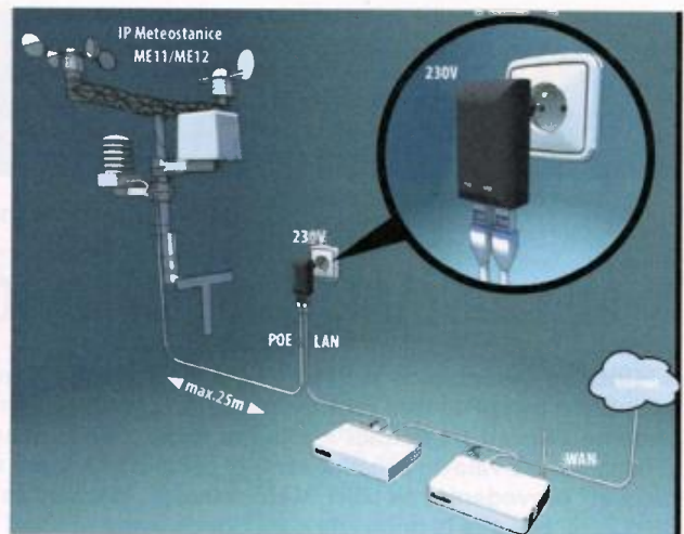
Připojení meteostanice k počítačové síti a napájení (PoE)
