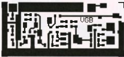
Obr. 11. Deska s plošnými spoji VGB (měřítko 1 : 1)
