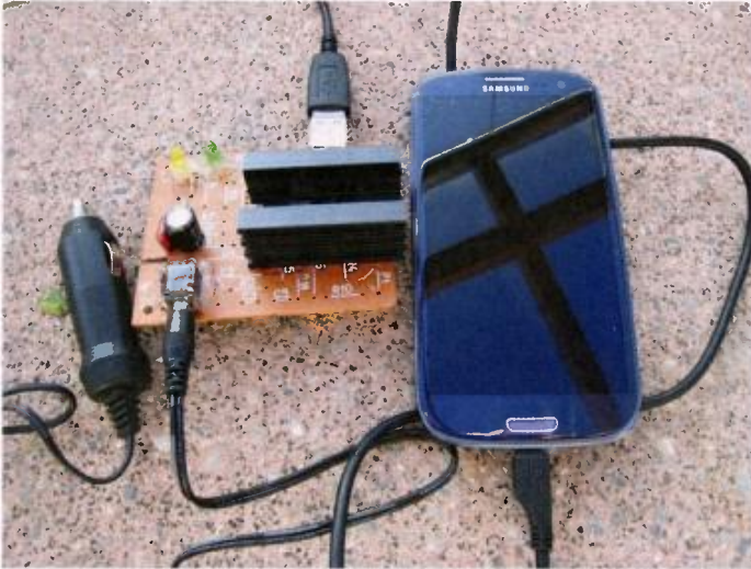
Obr. 6. Praktická realizácia nabíjačky z obr. 5
