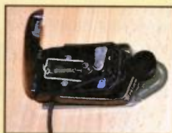
Obr. 26. Telegrafní klíč, součást radiostanice RM 31, tzv. „eremák“
