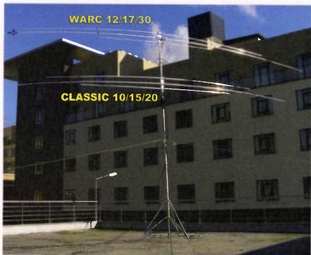
Trojice dipólů pro klasická i WARC pásma firmy EAntenna
