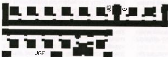
Obr. 7. Desky s plošnými spoji VGF a VGG (měřítko 1 : 1)
